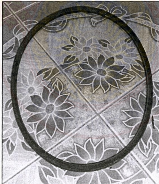
รูปที่ 3.27 ลักษณะของสายพานร่อง A ขนาดเส้นรอบวง 34 นิ้ว
