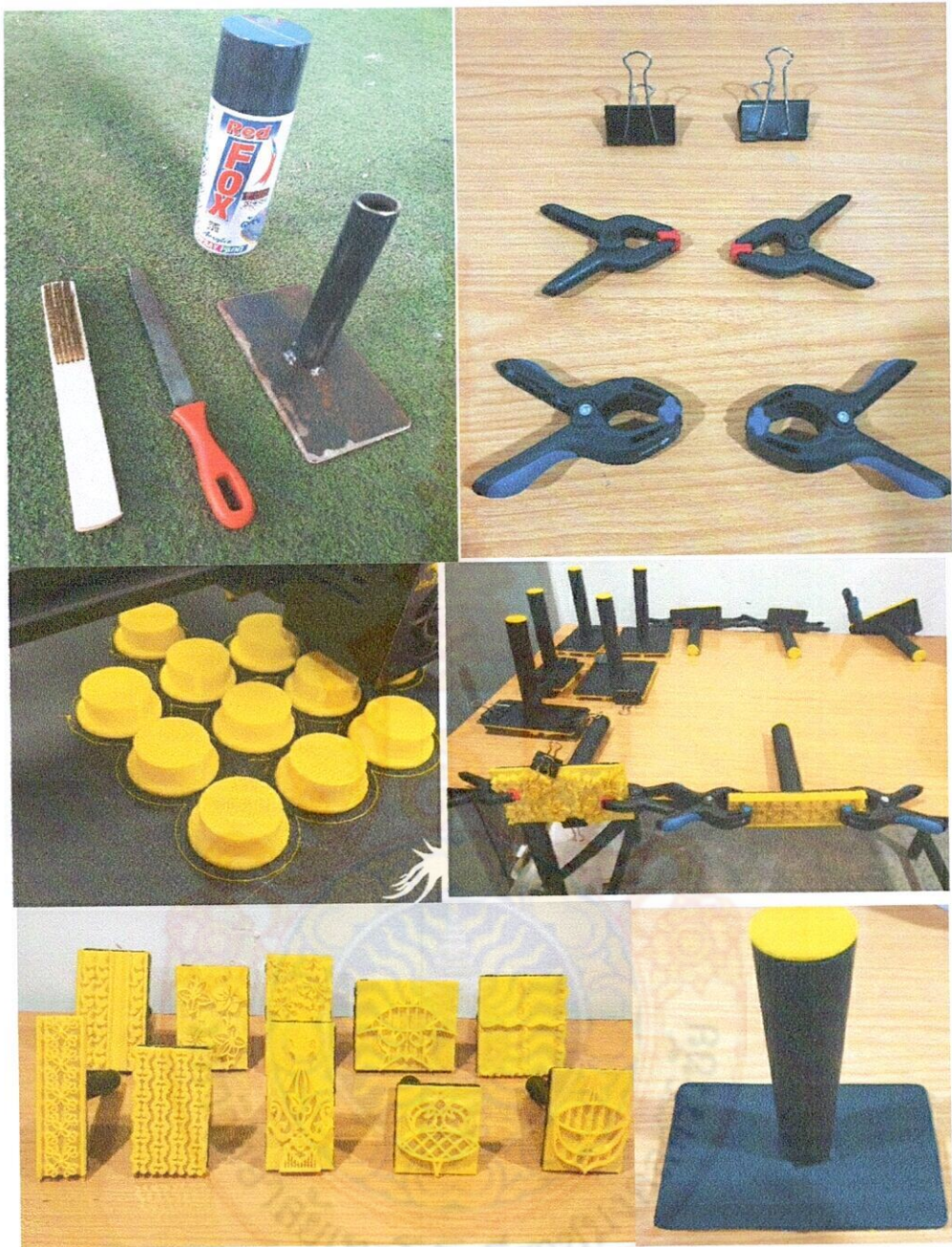
ภาพที่ 4-17: วัสดุยึดแผ่นแม่พิมพ์พลาสติก 3 มิติ ที่มา: ผู้วิจัย และคณะ, 2563
