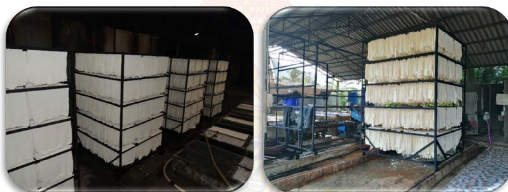
ภาพที่ 2.19 ขั้นตอนการพักแผ่นยางดิบให้สะอาดเตี้น้ำก่อนนำเข้าห้องอบ
