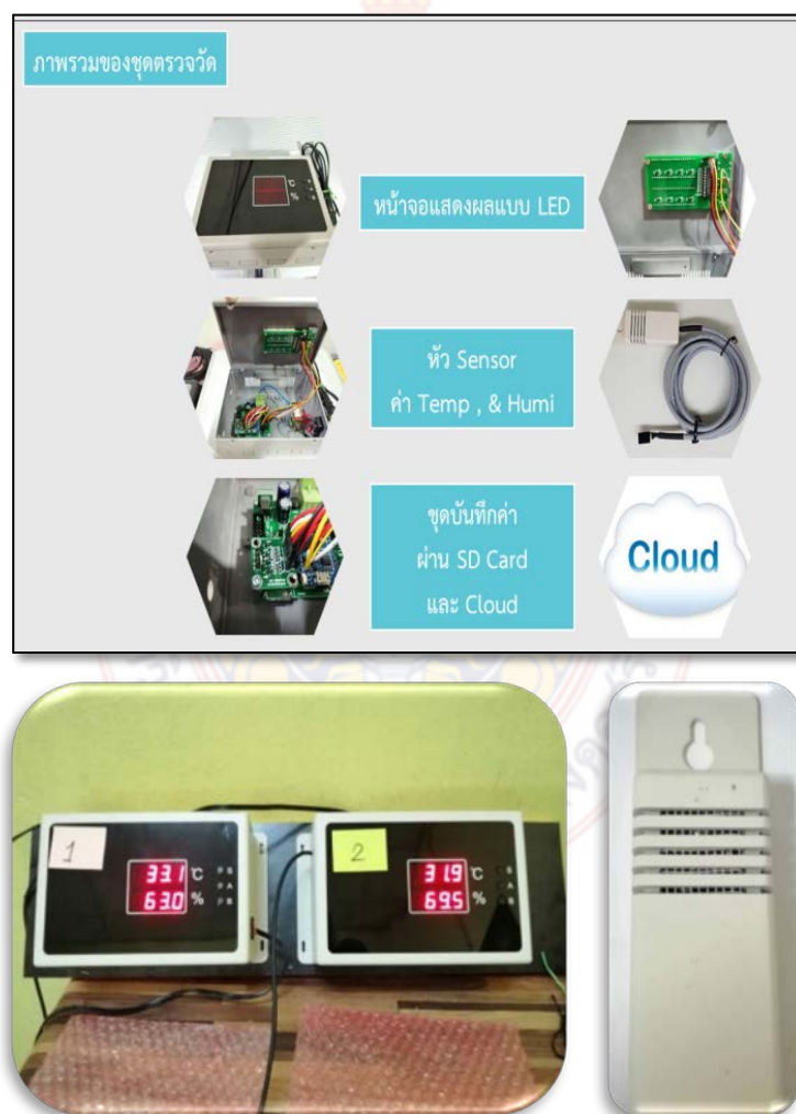
ภาพที่ 3.1 ชุดควบคุมระบบห้องรมควันยางแผ่นอัตโนมัติ
