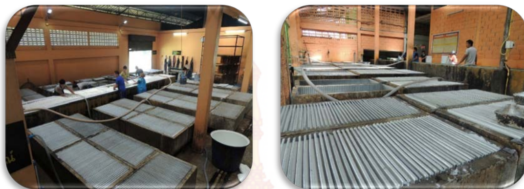
ภาพที่ 2.18 ขั้นตอนการแปรรูปน้ำยางสดเป็นยางแผ่นดิบ
