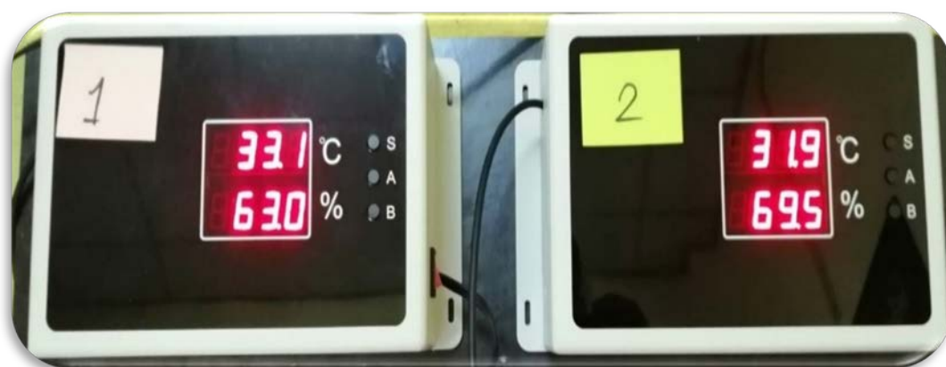
ภาพที่ 2.7 ชุดตรวจวัดค่าอุณหภูมิ และความชื้นสัมพัทธ์
