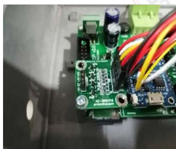
ภาพที่ 2.8 ภาพรวมของชุดตรวจวัดค่าอุณหภูมิ และความชื้นสัมพัทธ์
