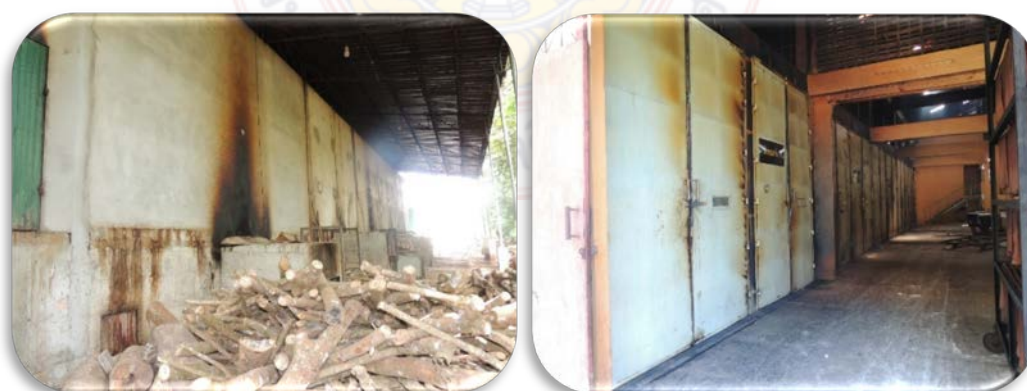
ภาพที่ 2.20 ห้องอบยางและเตาฟืนที่ใช้ในการอบแห้งยางแผ่นดิบ
