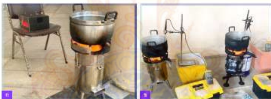
ภาพที่ 8 การทดสอบเตาประหยัดพลังงานต้นแบบ ก) การทดสอบเตา ทดค่าประสิทธิภาพและวัดค่าฝุ่น PM2.5 ข) การทดสอบค่าประสิทธิภาพเชิงความร้อนของเตา โดยเปรียบเทียบสมรรถนะจากปริมาณความร้อนเผาไหม้ 3 ระดับ
