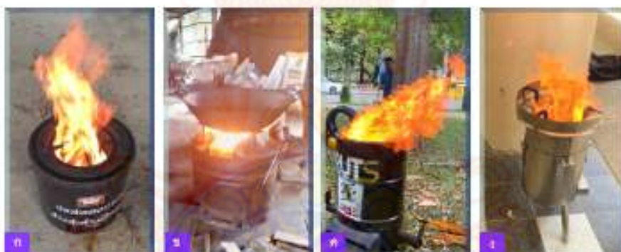
ภาพที่ 7 ลักษณะเตาประหยัดพลังงานที่ออกแบบและพัฒนา เพื่อประยุกต์ใช้ในกลุ่มชุมชนน้ำคอกอยู่เขตบางและวิทยาลัยชุมชนฯ ก) เตาประหยัดพลังงานชนิดถังโลหะขนาด 20 ลิตร ข) เตาประหยัดพลังงานชนิดถังโลหะ 200 ลิตร รูปทรงต่ำ ค) เตาประหยัดพลังงานชนิดถังโลหะ 200 ลิตร รูปทรงสูง และ ง) เตาประหยัดพลังงานสำหรับการแปรรูปสมุนไพร
