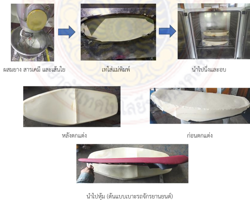
ภาพที่ 50 เบาะรถจักรยานยนต์ต้นแบบที่มีเส้นใยเปลือกหอยมากเป็นสารตัวเติม
