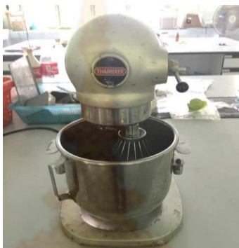
ภาพที่ 5 เครื่องตีฟองยางในการผลิตยางฟองน้ำ
