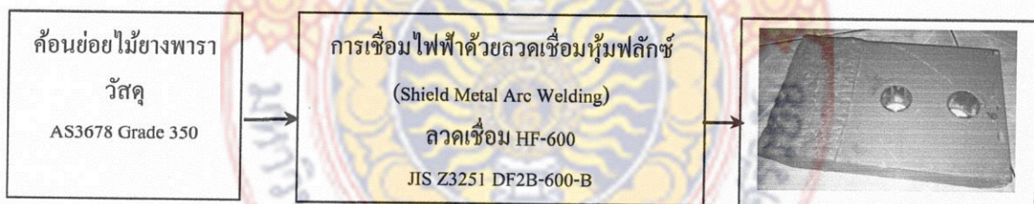
รูปที่ 3.1 กระบวนการเตรียมค้อนย่อยไม้ยางพาราก่อนการใช้งานและซ่อมแซม
