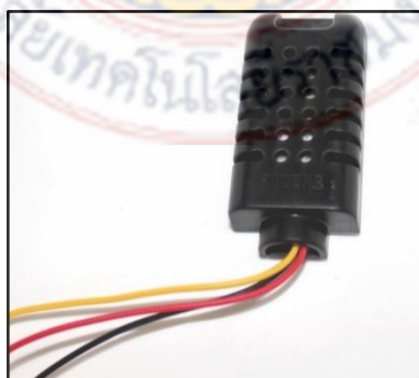
ภาพที่ 2.4 แสดงวงจรเซ็นเซอร์วัดอุณหภูมิและความชื้นสัมพัทธ์ AM2301-DHT21
