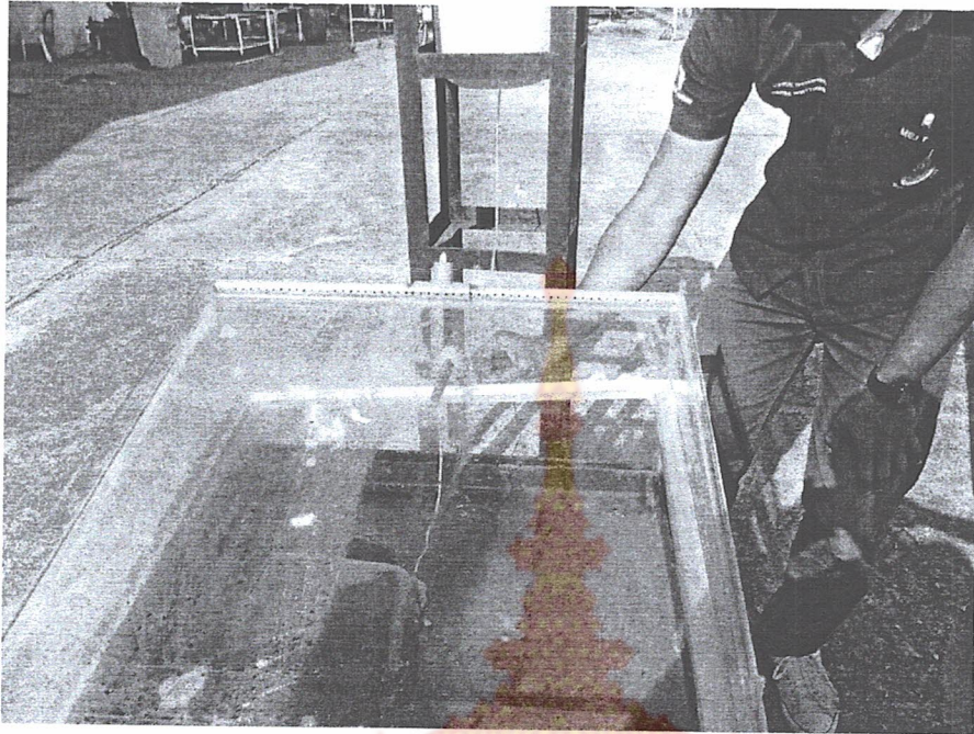
ภาพแสดงการติดตั้งสายเทอร์โมคัปเปิล
