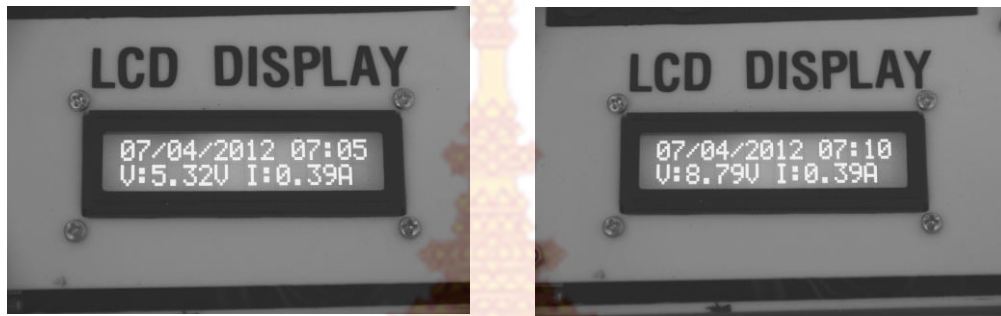
รูปที่ 4.8 ผลการจัดเก็บข้อมูลลงในหน่วยความจำอีอีพรอมและการแสดงผลผ่านจอแอลซีดี
