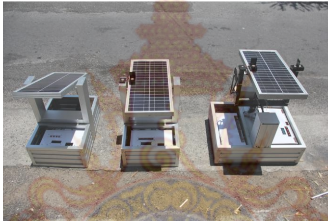
รูปที่ 12 ชุดทดสอบหาความเหมาะสมในการใช้งานของเครื่องผลิตพลังงานไฟฟ้าจากแผงเซลล์แสงอาทิตย์ ทั้ง 3 แบบ การประกอบวงจรเข้ากับโครงสร้างและการทดสอบการทำงาน
