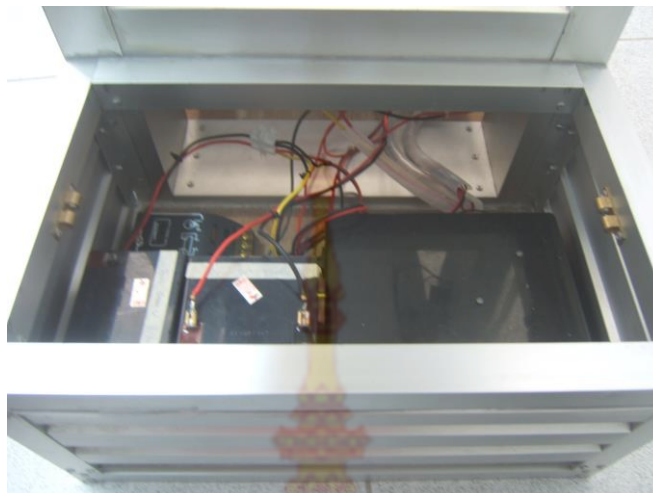
รูปที่ 3.38 การติดตั้งกล่องชุดควบคุมการเก็บประจุไฟฟ้าและเครื่องแปลงกระแสไฟฟ้า ภายในเครื่องผลิตพลังงานไฟฟ้าฯ แบบหมุนตามแสงอาทิตย์ชนิดแกนเดียว
