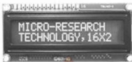
รูปที่ 3.27 ชุดแสดงผลขนาดอักขระ 16 ตัวอักษร 2 บรรทัด (16x2)
