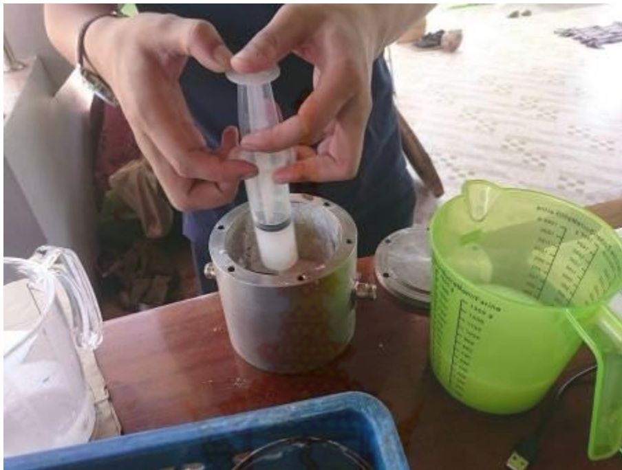
รูปที่ 13 การนำตัวอย่างน้ำยางพาราทดสอบในเซ็นเซอร์
