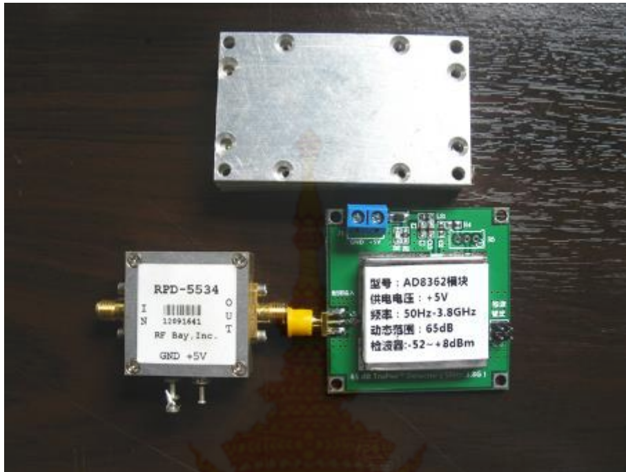
รูปที่ 5 รูป RF power Detector และ Low noise amplifier
