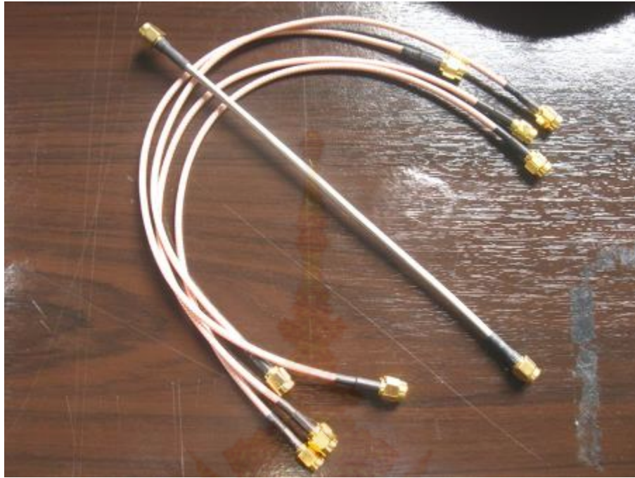
รูปที่ 3 สาย RF Coaxial Cable ความถี่สูง สำหรับเชื่อมต่อ
