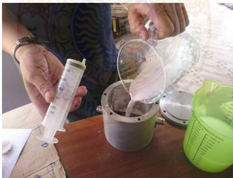
รูปที่ 14 บรรจุน้ำยางพาราธรรมชาติปริมาณ 200 มิลลิลิตร
