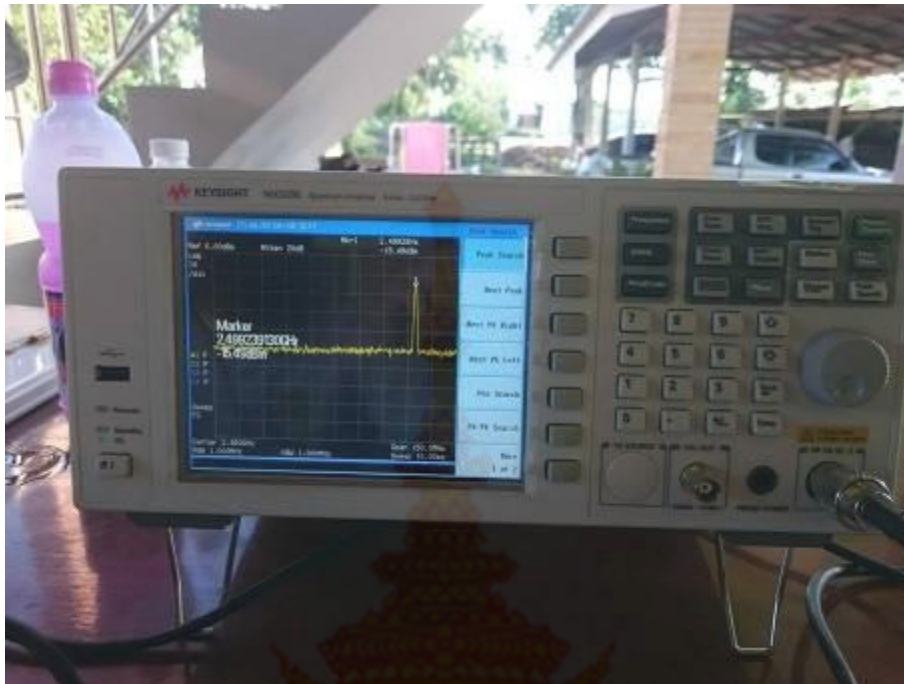
รูปที่ 9 การทดสอบวัดความถี่และค่าพลังงานของอุปกรณ์วงจรส่งเคราะห์ความถี่สูง
