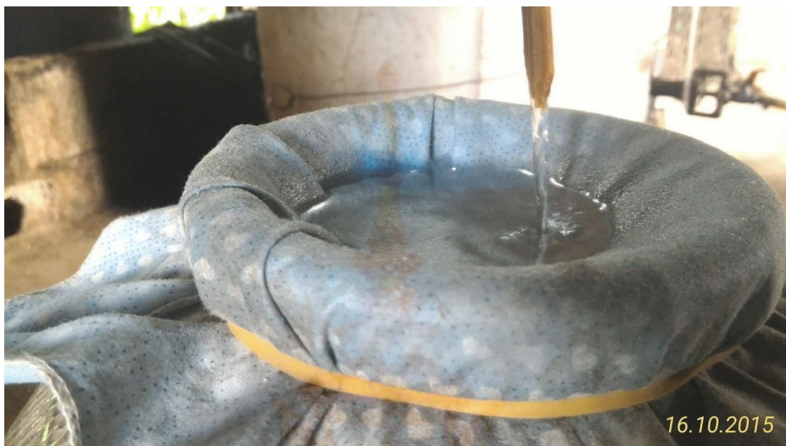
รูปที่ 4.2 ลักษณะของฟิวเซลอยที่ลอยอยู่บริเวณผิวหน้าระหว่างกลั่นสุราชุมชน
