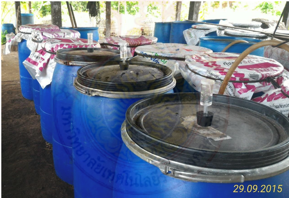
รูปที่ 3.1 การพัฒนากระบวนการหมักสุรากลั่นชุมชนจากน้ำตาลจาก โดยใช้อุปกรณ์กันอากาศ มาใช้ปิดปากถังหมัก
