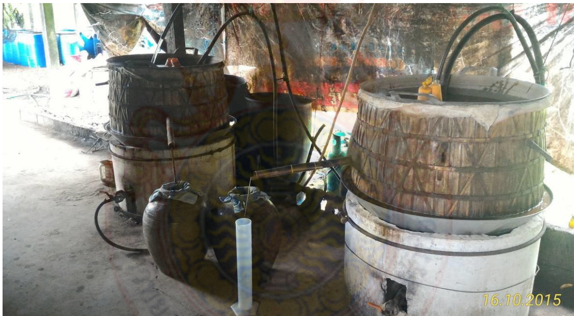
รูปที่ 3.2 อุปกรณ์ต้มกลั่นสุราชุมชนแบบภูมิปัญญาชาวบ้าน
