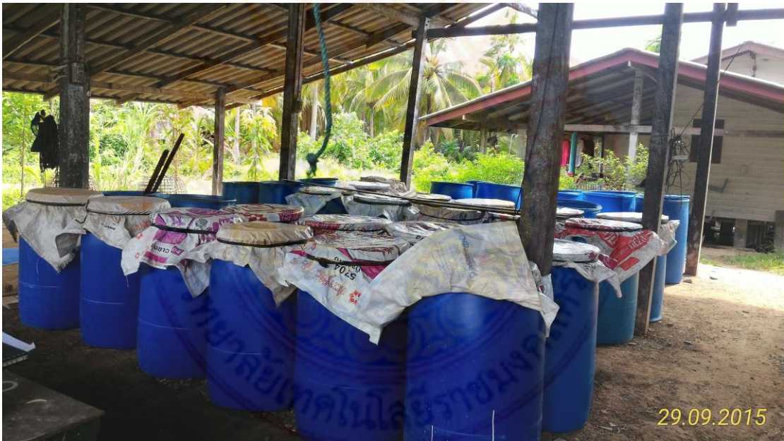
รูปที่ 1.1 กระบวนการหมักแบบดั้งเดิมของโรงงานผลิตสุรากลั่นชุมชนที่ใช้ภาชนะที่หมักเป็นถังพลาสติกสีฟ้าขนาดความจุ 200 ลิตรแล้วปากถังปิดด้วยกระสอบปุย
