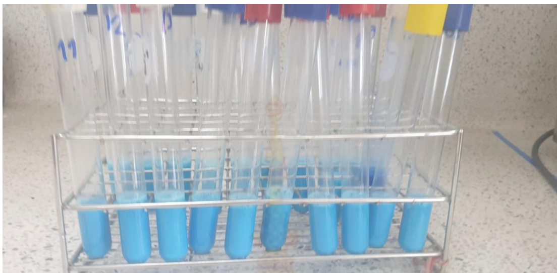
รูปภาพที่ 12 การทดสอบน้ำนมดิบด้วยการใช้สีเมธิลีนบลู (methylene blue reduction test, MBRT)
