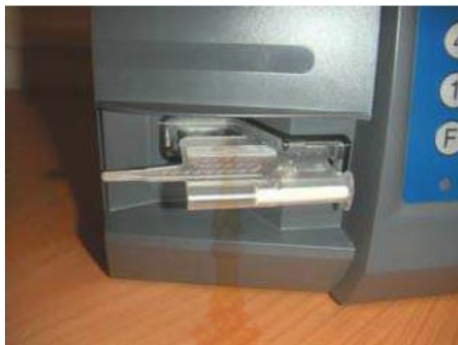
รูปภาพที่ 9 การนำ Sample milk cassette ใส่ในเครื่องตรวจโซมาติกเซลล์รุ่น DCC
