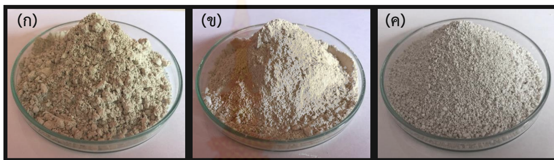
ภาพที่ 3.6 ลักษณะของผงตะกอน (ก) แคลเซียมคาร์บอเนตที่จากการเผาที่อุณหภูมิ 500 องศาเซลเซียส (ข) แคลเซียมคาร์บอเนตที่จากการเผาที่อุณหภูมิ 700 องศาเซลเซียส (ค) แคลเซียมคาร์บอเนตที่จากการเผาที่อุณหภูมิ 900 องศาเซลเซียส
