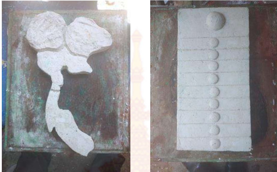
ภาพที่ 4.12: แสดงแม่พิมพ์หรือเบ้าหล่อที่สำเร็จแล้ว
