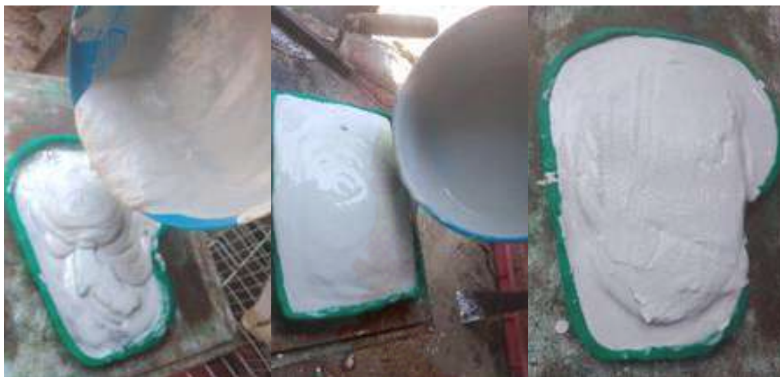
ภาพที่ 4.10: แสดงการเทปูนพลาสติกแม่พิมพ์ครอบ
