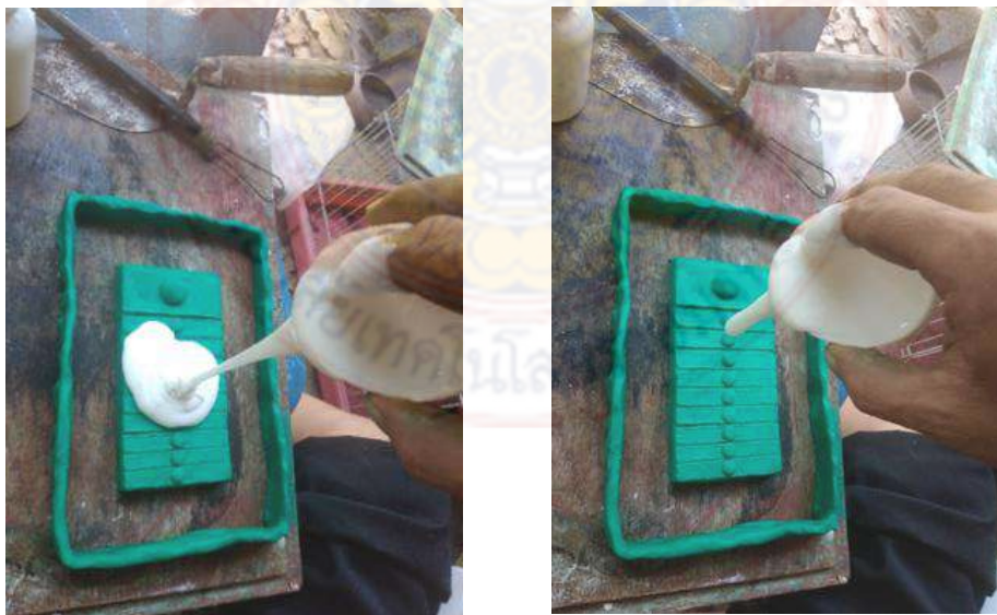
ภาพที่ 4.7: แสดงการผสมและเทยางซิลิโคนจากด้านบนสุด
