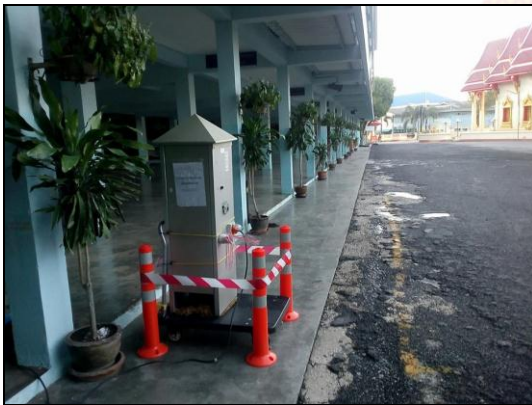
ภาพที่ 3.29 การตรวจวัดปริมาณฝุ่นละอองรวม (TSP) บริเวณโรงเรียนมัธยมวัดควนวิเศษมูลนิธิ
