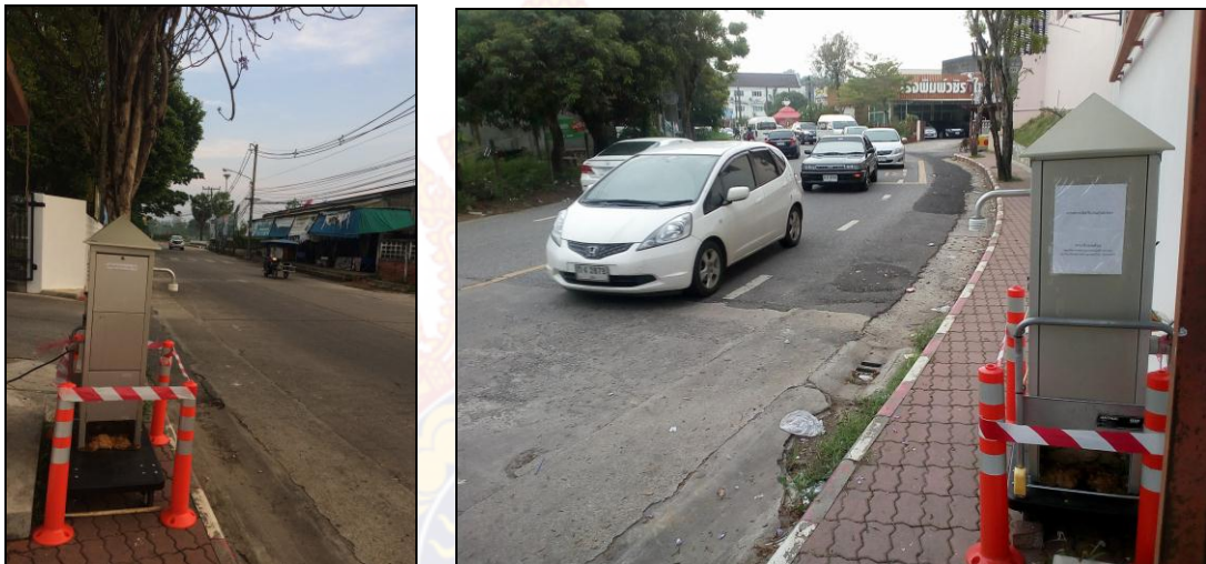
ภาพที่ 3.37 การตรวจวัดปริมาณฝุ่นละอองรวม (TSP) บริเวณหน้าโรงเรียนบูรณะรำลึก
