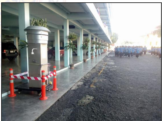
ภาพที่ 3.30 การตรวจวัดปริมาณฝุ่นละอองขนาดเล็ก ( PM_{10} ) บริเวณโรงเรียนมัธยมวัดควนวิเศษมูลนิธิ
