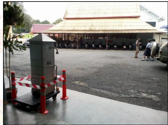
ภาพที่ 3.29 การตรวจวัดปริมาณฝุ่นละอองรวม (TSP) บริเวณโรงเรียนมัธยมวัดควนวิเศษมูลนิธิ
