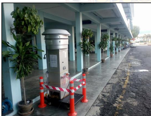
ภาพที่ 3.30 การตรวจวัดปริมาณฝุ่นละอองขนาดเล็ก ( PM_{10} ) บริเวณโรงเรียนมัธยมวัดควนวิเศษมูลนิธิ
