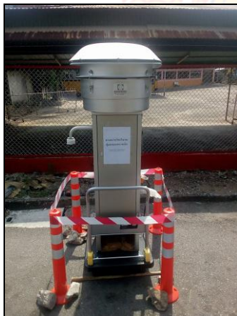
ภาพที่ 3.22 การตรวจวัดปริมาณฝุ่นละอองขนาดเล็ก ( PM_{10} ) บริเวณหน้าโรงเรียนวัฒนาศึกษา
