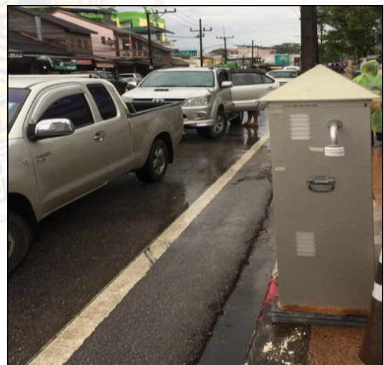
ภาพที่ 3.1 การตรวจวัดปริมาณฝุ่นละอองรวม (TSP) บริเวณหน้าโรงเรียนตรังคริสเตียนศึกษา
