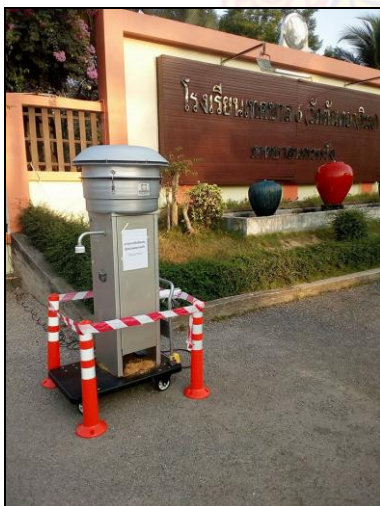
ภาพที่ 3.46 การตรวจวัดปริมาณฝุ่นละอองขนาดเล็ก ( PM_{10} ) บริเวณหน้าโรงเรียนเทศบาล 6 (วัดตันตยาภิรม)
