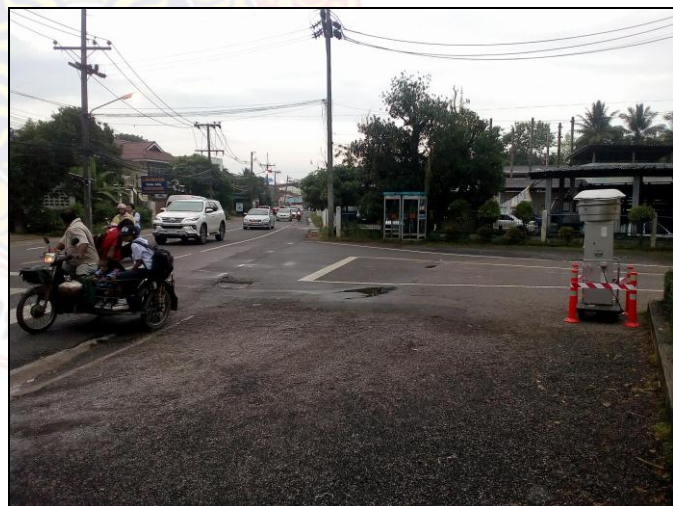
ภาพที่ 3.46 การตรวจวัดปริมาณฝุ่นละอองขนาดเล็ก ( PM_{10} ) บริเวณหน้าโรงเรียนเทศบาล 6 (วัดตันตยาภิรม)
