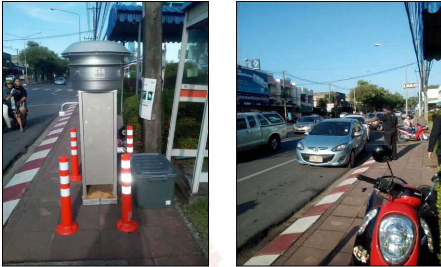
ภาพที่ 3.10 การตรวจวัดปริมาณฝุ่นละอองขนาดเล็ก ( PM_{10} ) บริเวณ หน้าโรงเรียนปัญญาวิทย์ (ประถมศึกษา)
