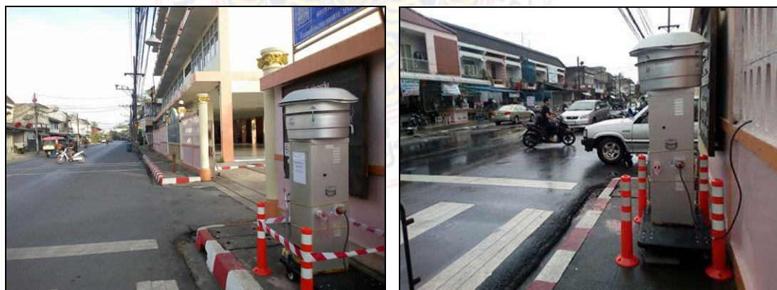
ภาพที่ 3.50 การตรวจวัดปริมาณฝุ่นละอองขนาดเล็ก ( PM_{10} ) บริเวณหน้าโรงเรียนเทศบาล 1 (สังขวิทย์)
