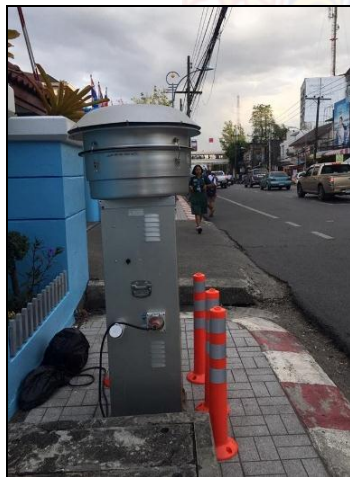
ภาพที่ 3.14 การตรวจวัดปริมาณฝุ่นละอองขนาดเล็ก ( PM_{10} ) บริเวณหน้าโรงเรียนสภาราชินี
