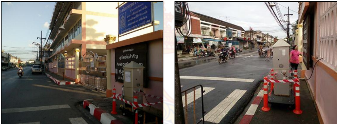
ภาพที่ 3.49 การตรวจวัดปริมาณฝุ่นละอองรวม (TSP) บริเวณหน้าโรงเรียนเทศบาล 1 (สังขวิทย์)
