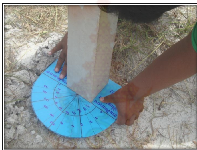
ภาพที่ 17 การสร้างเส้นแนวตั้งฉากกับแนวชายฝั่งในการติดตั้งหลักมุดอ้างอิง
