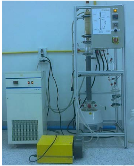
รูปที่ 8 เครื่องกลั่นเอทานอลแบบเบดบรรจุ
