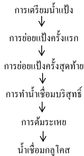
รูปที่ 3 กระบวนการผลิตน้ำเชื่อมกลูโคส
