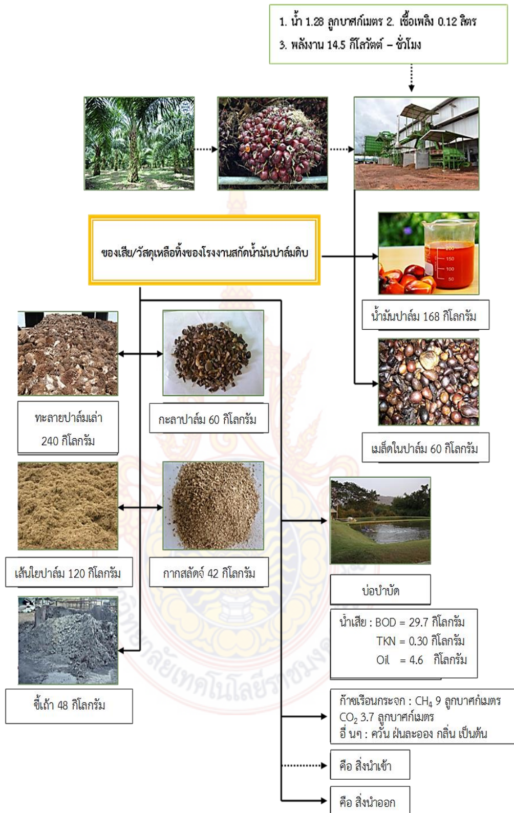
ภาพที่ 1 ส่วนประกอบต่าง ๆ ที่ได้จากการสกัดน้ำมันปาล์ม แหล่งที่มา: ดัดแปลงมาจาก (Chavalparit et al. , 2006)
