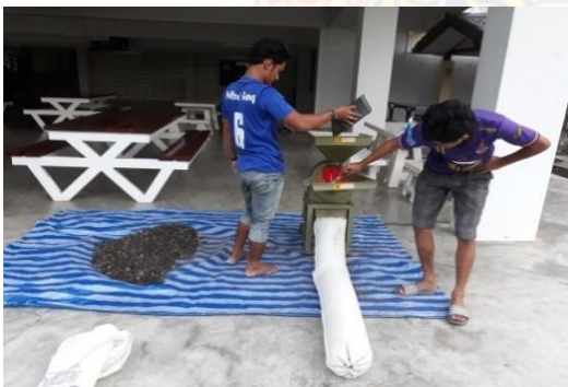
ภาคผนวก จ5 นำกากตะกอนน้ำมันปาล์มแห้ง บดด้วยเครื่องบดละเอียด
