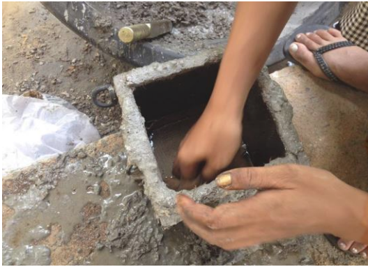
ภาพผนวกที่ ญ1 (ก) ทำการเช็ดบล็อกด้วยน้ำมัน
