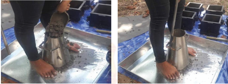
ภาพที่ ฐ3 ตักคอนกรีตใส่ลงในแบบ และใช้เหล็กกระทุ้ง
