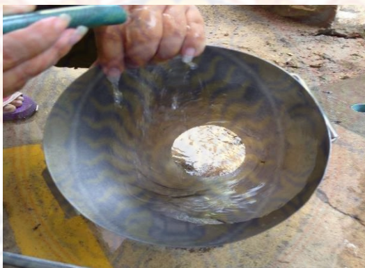
ภาพที่ ฎ2 นำแบบไปชุบน้ำให้ผิวเปียกเพื่อให้การเทไหลของคอนกรีตได้ดี
