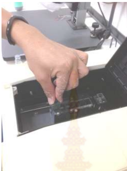
ภาพผนวกที่ ค.3 หาความหนาแน่นเซลล์สาหร่ายด้วยการวัดค่า OD
