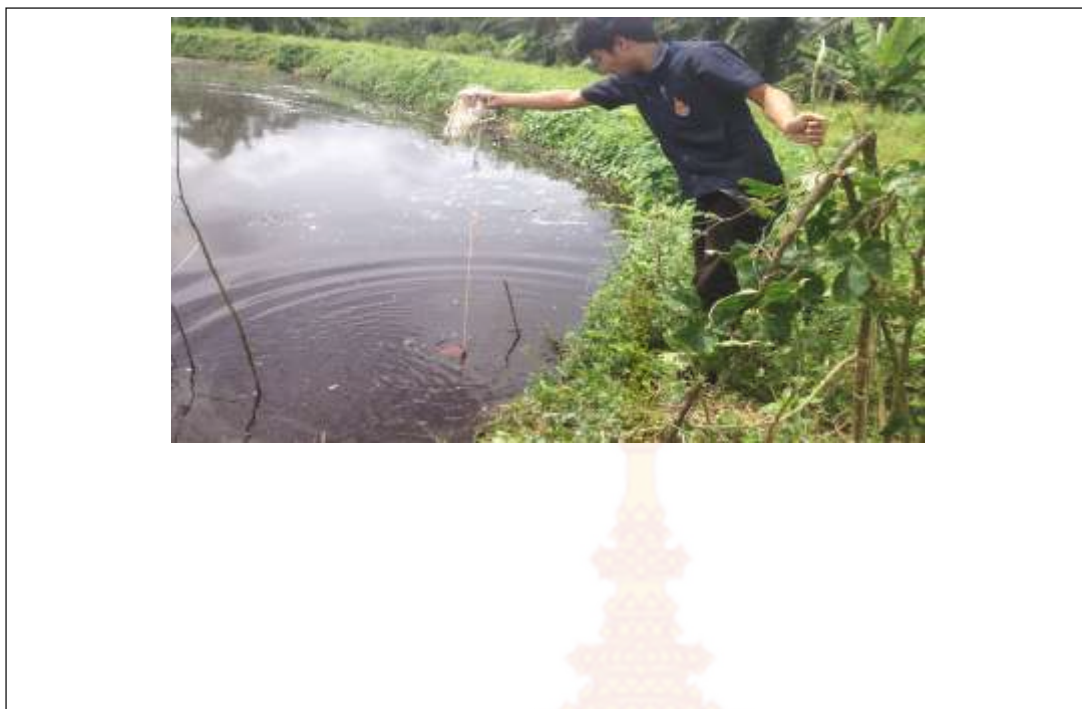
ภาพผนวกที่ ก.7 ภาพการวัดความโปร่งแสงน้ำทิ้งบ่อสุดท้ายโรงงานปาล์มน้ำมันตรง 2
