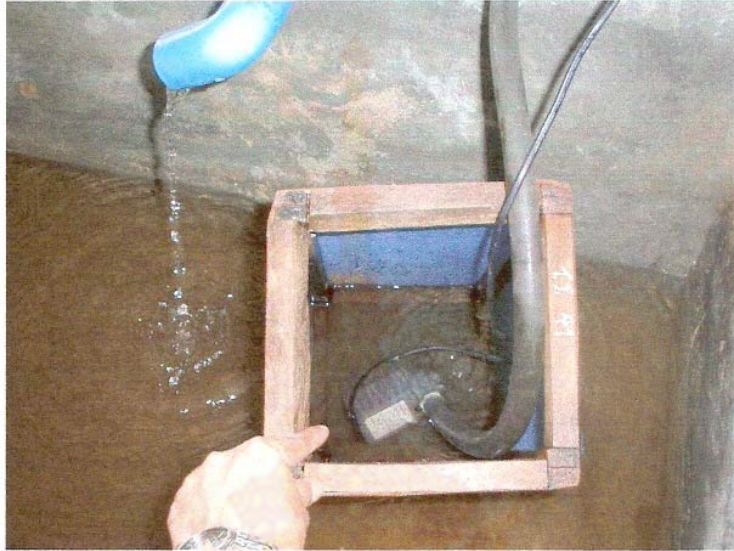
รูปผนวกที่ 5 มีการใช้เครื่องดูดน้ำขนาดเล็ก ดึงน้ำในบ่อเลี้ยงปลาไปผ่านระบบกรองชีวภาพ
