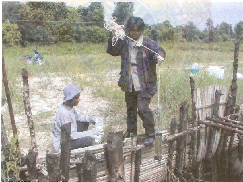
รูปผนวกที่ 20 ทำการเก็บตัวอย่างน้ำในบ่อบำบัดน้ำทิ้ง
