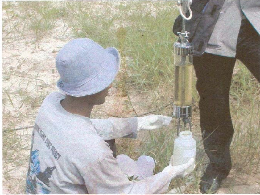
รูปผนวกที่ 21 เก็บน้ำตัวอย่างในบ่อบำบัดน้ำทิ้ง เพื่อนำไปวิเคราะห์หาคุณสมบัติของน้ำ
