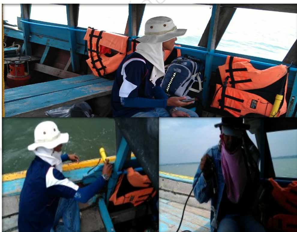
ภาพที่ 58 การวัดพิกัดโดยใช้เครื่อง GPS และทำการ mark จุด พร้อมกับสำรวจความลึก สำหรับการหาพื้นที่หน้าตัดของแม่น้ำ
