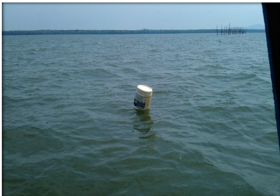
ภาพที่ 55 แสดงการติดตั้งเครื่องมือวัดกระแสน้ำที่ระดับ 1 เมตร และ 4 เมตร จากผิวน้ำ
