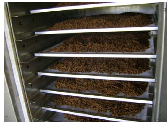
รูปผนวกที่ 6 อบอาหารที่ผ่านการอัดเม็ดแล้วใน ตู้อบความร้อน 60 องศาเซลเซียส
