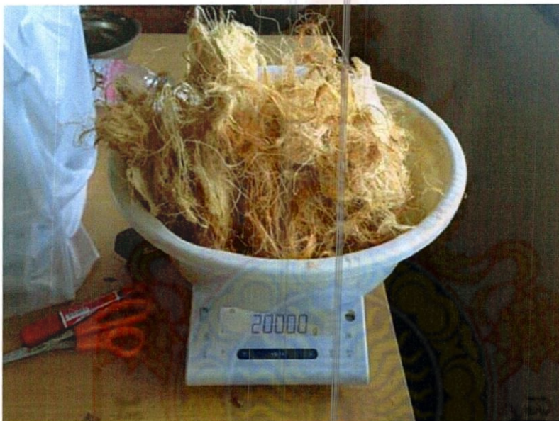
ภาพที่ 29 แสดงการชั่งน้ำหนักเส้นใยลูกตาลจากการคำนวณปริมาณตามความหนาแน่นที่กำหนด
