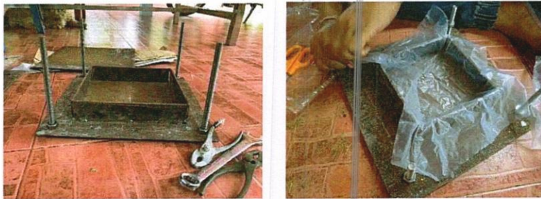
ภาพที่ 20 แสดงแบบเครื่องกวดอัดโดยไม่ใช้ความร้อน
