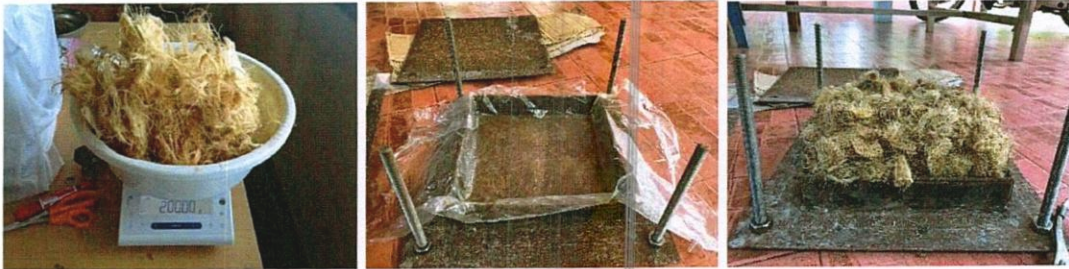
ภาพที่ 30 การนำเส้นใยลูกตาลกับน้ำยางธรรมชาติที่ซึ่งได้มาผสมกันขึ้นรูปในบล็อกเหล็กด้วยวิธีการฉีดพ่นประสาน
