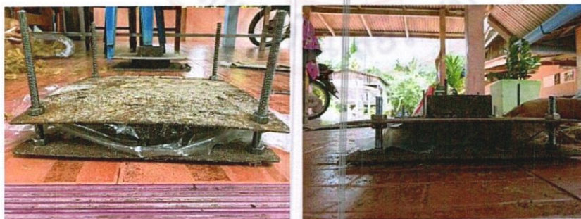
ภาพที่ 32 แสดงการกดอัดด้วยเครื่องอัดที่ไม่ใช้ความร้อนกดทิ้งไว้ 24 ชั่วโมง
