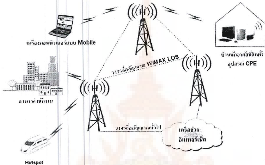
ภาพที่ ผ-11 รูปแบบการให้บริการสื่อสารไร้สายอัตราเร็วสูงโดยเทคโนโลยี WiMAX
