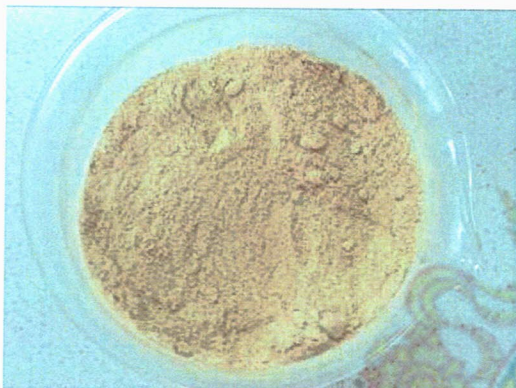
รูปที่ 17 ลักษณะทางปาล์มที่บดละเอียดขนาด 1-2 มิลลิเมตร
