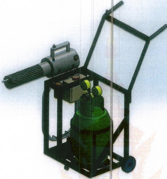
รูปที่ ก.7 แบบของเครื่องพ่นหมอกควันกำจัดยุง
