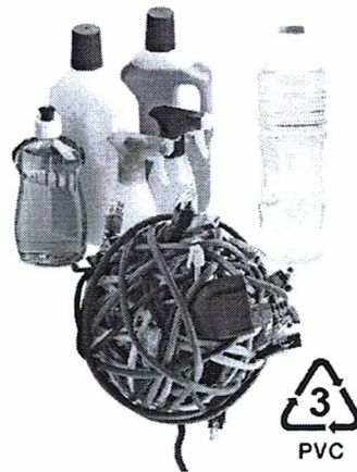
รูปที่ 2.12 สัญลักษณ์และผลิตภัณฑ์โพลีไวนิลคลอไรด์
