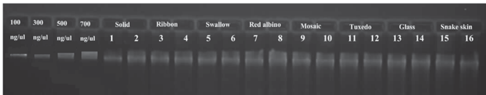
ภาพที่ 1 pool DNA ของปลาหางนกยูง ทั้ง 8 สายพันธุ์ จากการตรวจสอบคุณภาพ และปริมาณด้วย agarose gel เปรียบเทียบกับ ดีเอ็นเอมาตรฐาน ( \lambda DNA) ที่มีความเข้มข้น 100, 300, 500 และ 700 นาโนกรัมต่อไมโครลิตร (1-16 = ปลาหางนกยูงแต่ละสายพันธุ์ที่ใช้ในการทดลอง)
