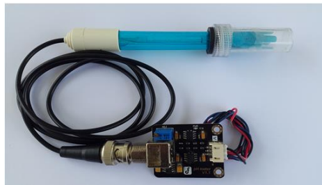
ก. อุปกรณ์วัดค่าความเป็นกรด-ด่าง (pH Sensor)
