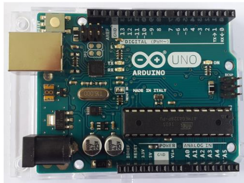
ภาพที่ 3 อุปกรณ์ไมโครคอนโทรลเลอร์ Arduino UNO R3
