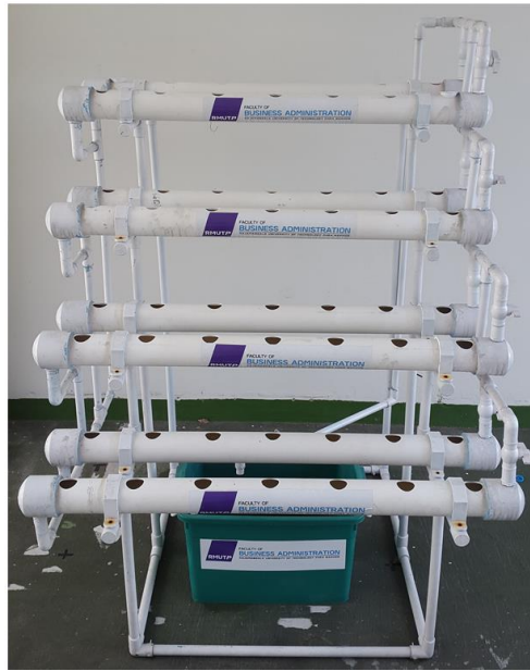
ภาพที่ 1 โต๊ะปลูกทำจากท่อพีวีซีสำหรับการปลูกผักสลัดแบบระบบไฮโดรโปนิกส์ ระบบ DRFT
