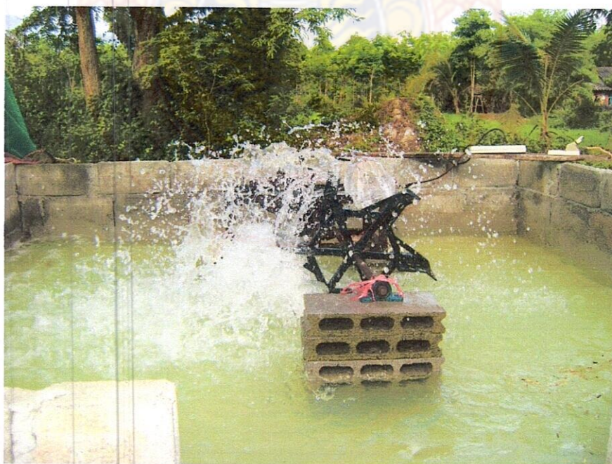
รูปที่ 4.13 แสดงการตีน้ำของใบพัดเติมอากาศ (แบบเก่า)
