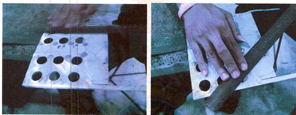
รูปที่ 3.12 แสดงการลอบคมใบพัดด้วยตะไบ
