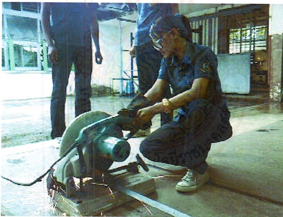
รูปที่ 3.5 แสดงการตัดเหล็กเพื่อใช้ในการทำโครงเป็นส่วนรองรับใบพัด
