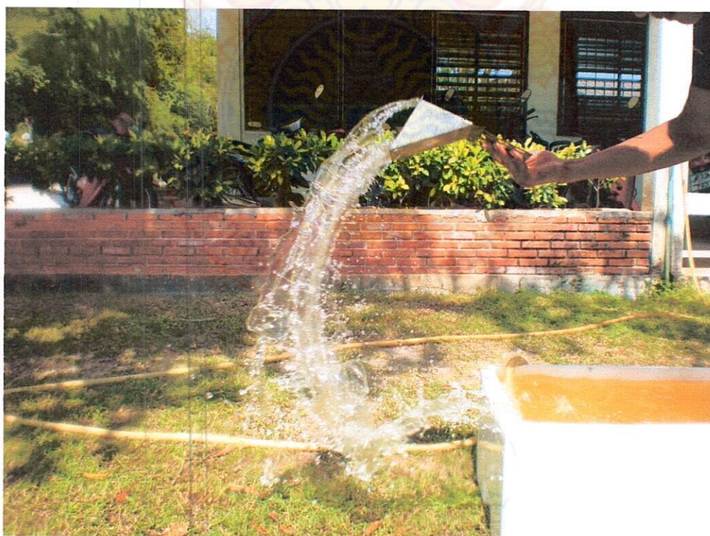
รูปที่ 4.4 แสดงความกว้างของรู 0.8 cm. ตักน้ำไถระยะ 0.9 m. เวล่าน้ำหมด 1-2 s
