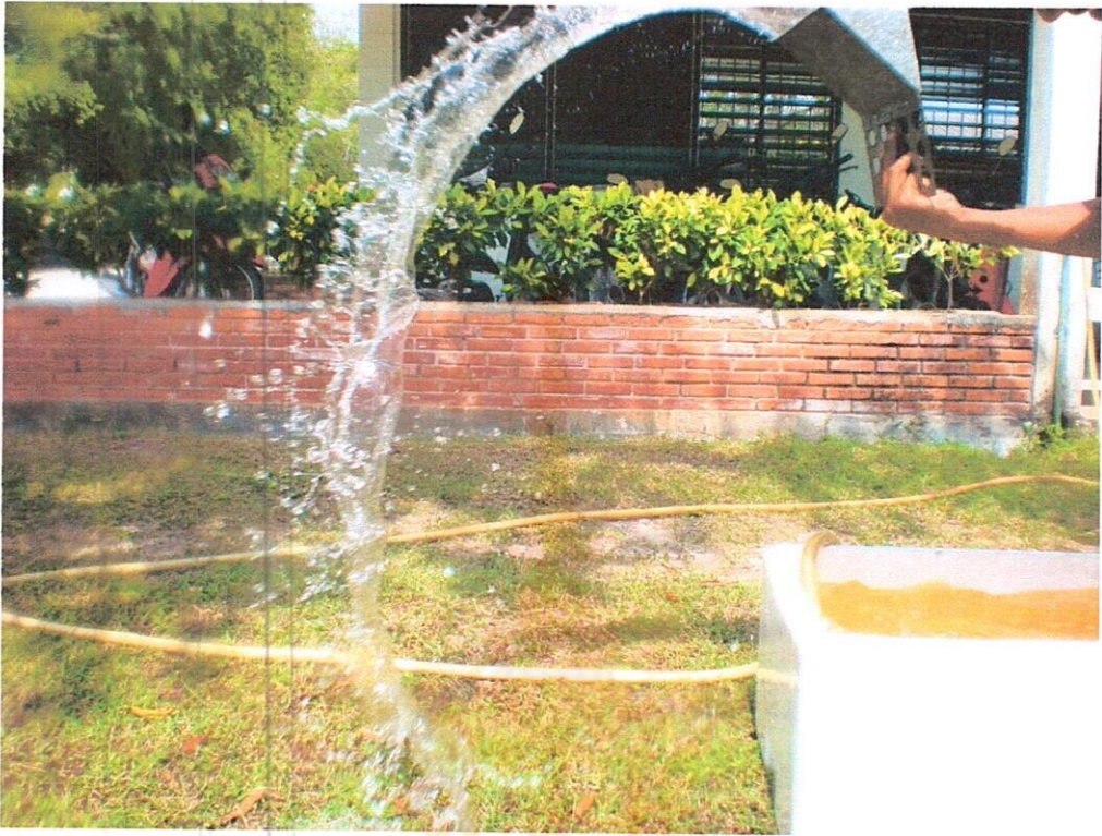
รูปที่ 4.5 แสดงความกว้างของรู 1.0 cm. ตักน้ำไถระยะ 1 m. เวลาน้ำหมด 1 s
