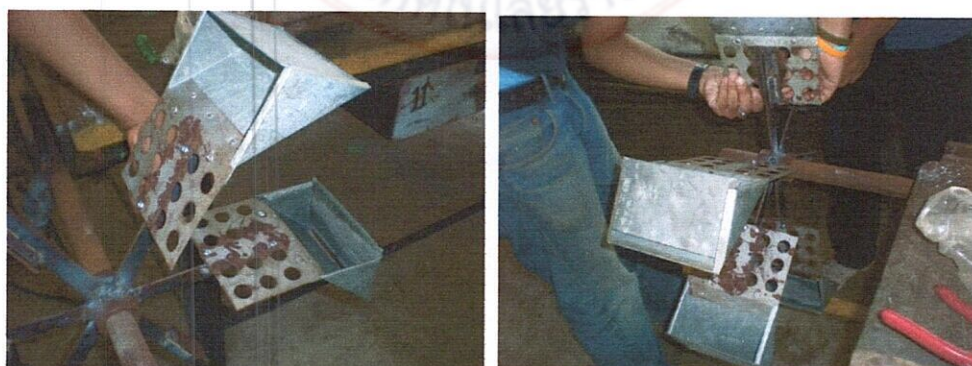
รูปที่ 3.19 แสดงการประกอบใบพัดเข้ากับโครง
