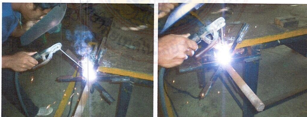
รูปที่ 3.16 แสดงการขึ้นโครงแกนใบพัดเพื่อใช้ในการรองรับใบพัด
