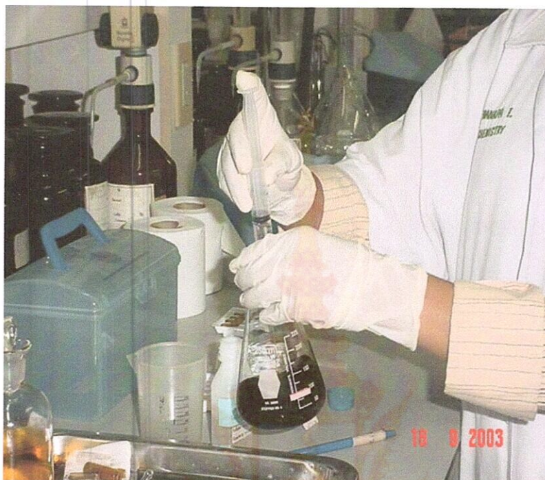
รูปที่ 2.25 แสดงการหยดสารละลายมาตรฐาน โซเดียมโคริออกซ์เพด
