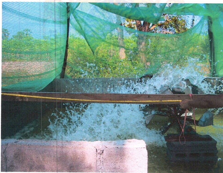
รูปที่ 4.9 แสดงใบพัดเติมอากาศต้นแบบตีน้ำได้ไกลเป็นระยะ 1.67 เมตร
