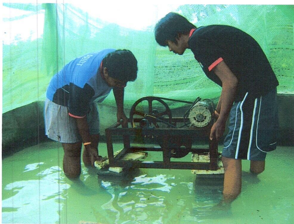
รูปที่ 4.14 แสดงการติดตั้งใบพัดเติมอากาศ
