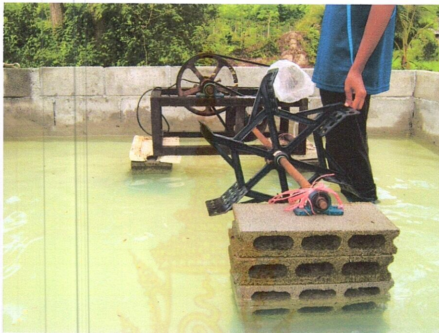
รูปที่ 4.12 แสดงการติดตั้งใบพัดเติมอากาศ (แบบเก่า)
