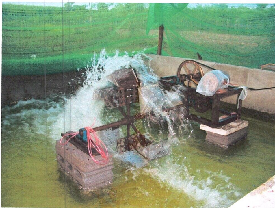
รูปที่ 4.8 แสดงใบพัดเติมอากาศต้นแบบตีน้ำซึ่งถ่ายจากมุมด้านขวา
