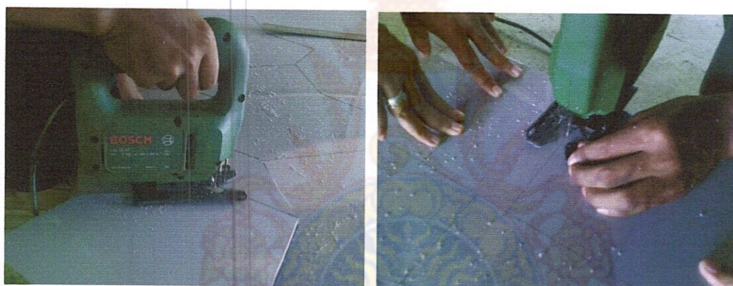
รูปที่ 3.21 แสดงการตัดใบพัดเติมอากาศตามแบบที่ร่างไว้
