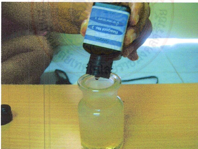
รูปที่ 4.30 แสดงการหยดสารละลายกรดซัลฟูริก
