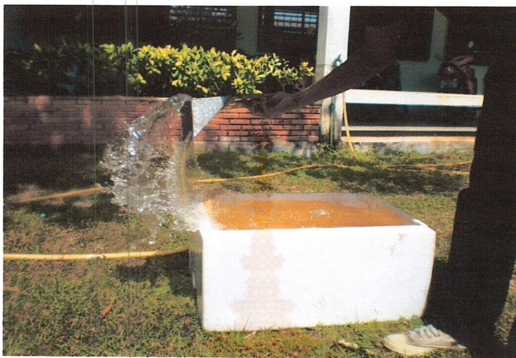
รูปที่ 4.3 แสดงความกว้างของรู 0.5 cm. ตักน้ำไถระยะ 0.8 m. เวล่าน้ำหมด 3-4 s
