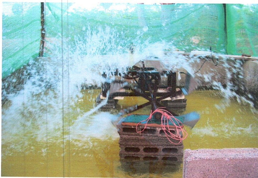
รูปที่ 4.6 แสดงใบพัดเติมอากาศต้นแบบตีน้ำซึ่งถ่ายจากด้านหน้า
