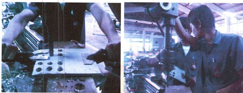
รูปที่ 3.11 แสดงการเจาะรู ขนาด \varnothing 20 mm. จำนวน 12 รู เพื่อลดแรงเสียดทานระหว่างน้ำกับใบพัด
