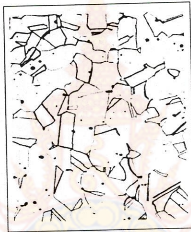
ภาพที่ 2-4 โครงสร้างจุลภาคของ Stainless Steel 304 กำลังขยาย 250 เท่า
