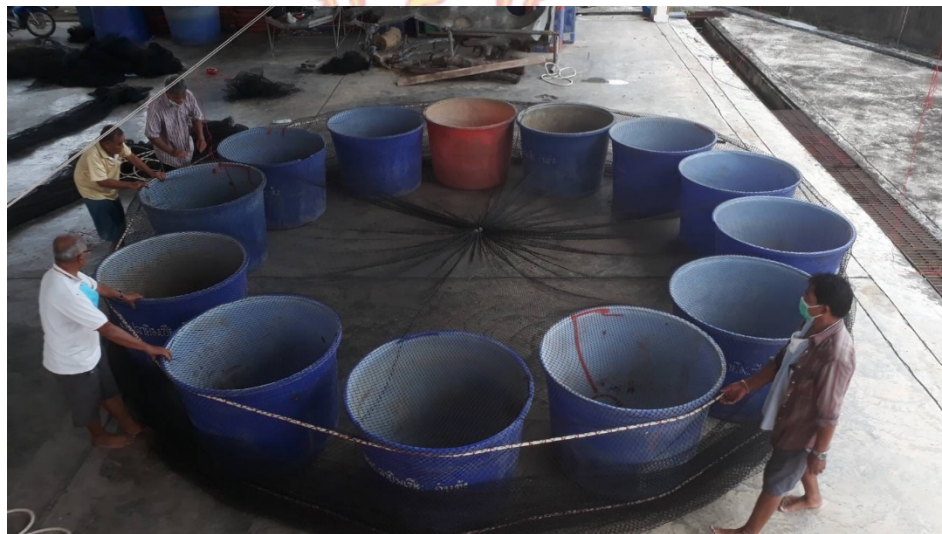
ภาพที่ 24 การตัดเย็บส่วนท้ายตาข่ายอวน ขนาดเส้นผ่านศูนย์กลาง 6 เมตร ความลึก 5 เมตร สำหรับการประกอบเป็นกระชังเลี้ยงปลาในทะเล
