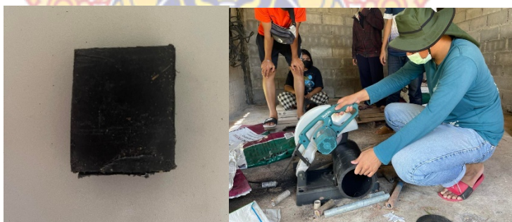
ภาพที่ 13 การเตรียมตัวอย่างพลาสติก HDPE ขนาด 4 x 4 เซนติเมตร
