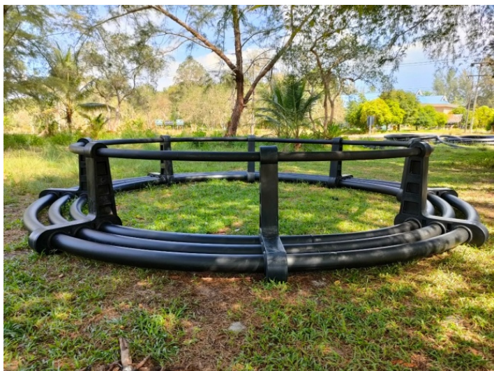
ภาพที่ 22 ชุดการทดลองที่ 3 ผลิภัณฑ์กระชังต้นแบบสำหรับการเลี้ยงสัตว์น้ำอัตราส่วนผสมของเม็ดพลาสติกใหม่กับเม็ดพลาสติกรีไซเคิล 50 : 50
