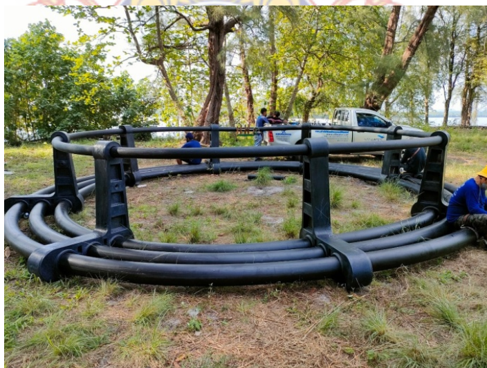
ภาพที่ 21 ชุดการทดลองที่ 2 ผลิตรังนกกระชังต้นแบบสำหรับการเลี้ยงสัตว์น้ำอัตราส่วนผสมของ เม็ดพลาสติกใหม่กับเม็ดพลาสติกรีไซเคิล 30 : 70
