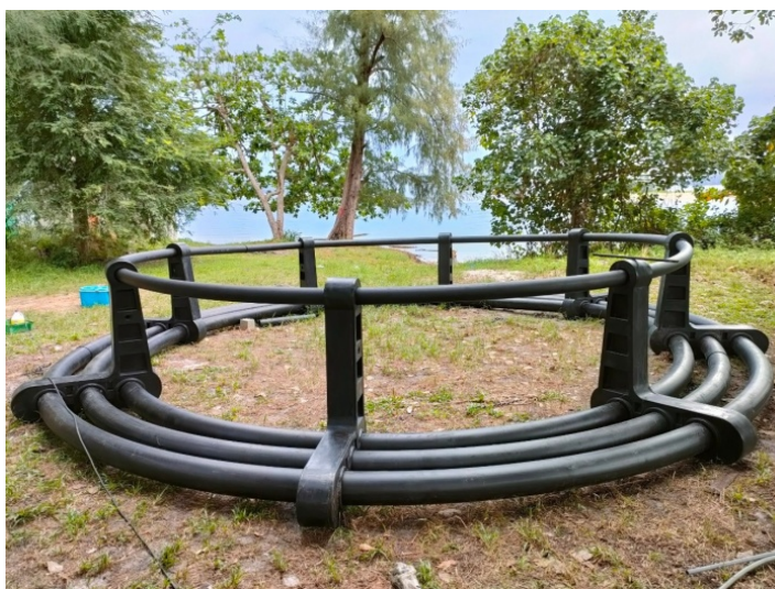
ภาพที่ 20 ชุดการทดลองที่ 1 ผลิตรังนกกระชังต้นแบบสำหรับการเลี้ยงสัตว์น้ำอัตราส่วนผสมของ เม็ดพลาสติกใหม่กับเม็ดพลาสติกรีไซเคิล 70 : 30
