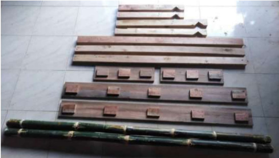
ภาพที่ 4.59 ต้นแบบแคร่ฝักยกพื้นชนิดแยกประกอบที่มีอายุการใช้งานมากกว่าไม้ไผ่ ที่มา: คณะผู้วิจัย, 2565
