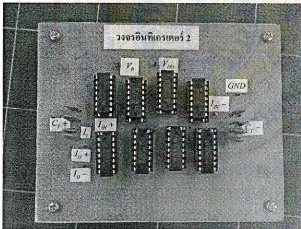
(ค) วงจรอินทิเกรเตอร์ที่ประกอบลงแผ่นวงจรพิมพ์ รูปที่ ผ.1 วงจรอินทิเกรเตอร์ที่ใช้ในการทดลอง ชุดที่ 1
