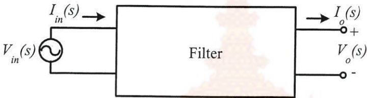
รูปที่ 4.1 บล็อกไดอะแกรมวงจรกรองความถี่
