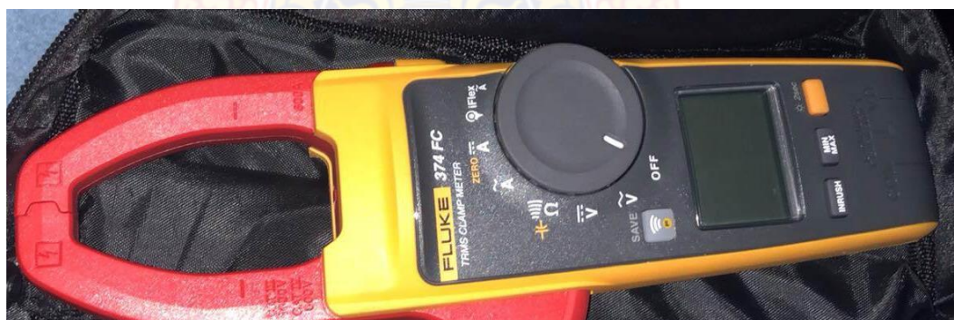
ภาพที่ 3.5 เครื่องมือวัดค่าพลังงานไฟฟ้า
