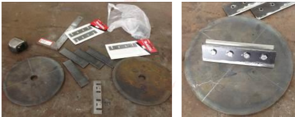
ภาพที่ 2.1 ประกอบใบมีดสับทางปาล์มน้ำมัน
