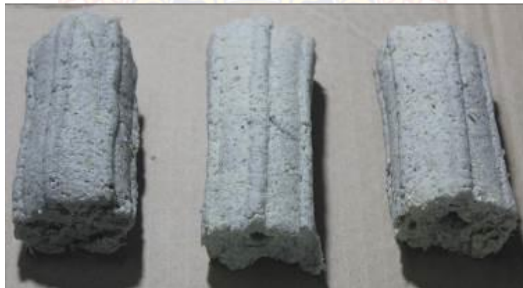
ภาพที่ 3.7 แท่งเชื้อเพลิงที่อัดได้จากสัดส่วนผสม 1:1:0.4
