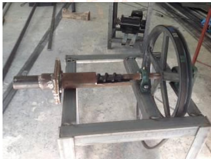
ภาพที่ 2.10 ติดตั้งเกลียวอัด ครอบอกเกลียวอัดและปากอัดแท่งเชื้อเพลิงชีวมวล
