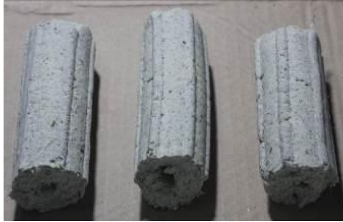
ภาพที่ 3.6 แท่งเชื้อเพลิงที่อัดได้จากสัดส่วนผสม 1:1:0.3
