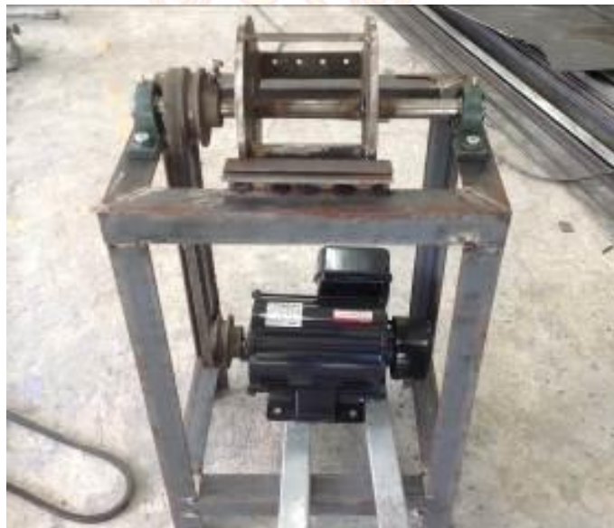
ภาพที่ 2.4 ติดตั้งชุดพูลเลย์ สายพานและมอเตอร์ต้นกำลัง
