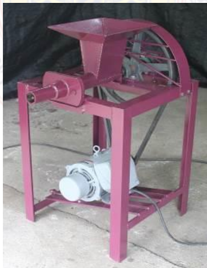
ภาพที่ 2.12 เครื่องอัดแท่งเชื้อเพลิงชีวมวล
