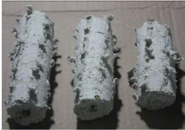
ภาพที่ 3.4 แท่งเชื้อเพลิงที่ได้จากส่วนผสม 1:1:0.1
