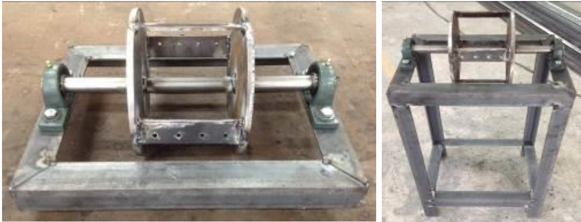
ภาพที่ 2.3 ประกอบตัวโครงเครื่องกับชุดลูกกลิ้งสับทางปาล์มน้ำมัน
