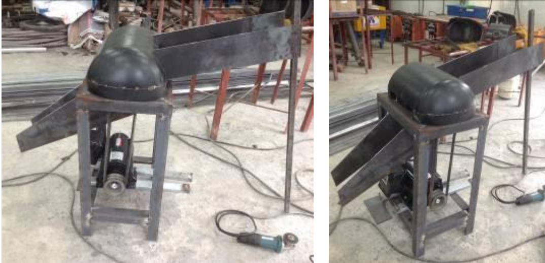
ภาพที่ 2.5 สร้างตัวครอบชุดใบมีดสับ ช่องทางป้อนและทางออกทางปาล์มน้ำมัน
