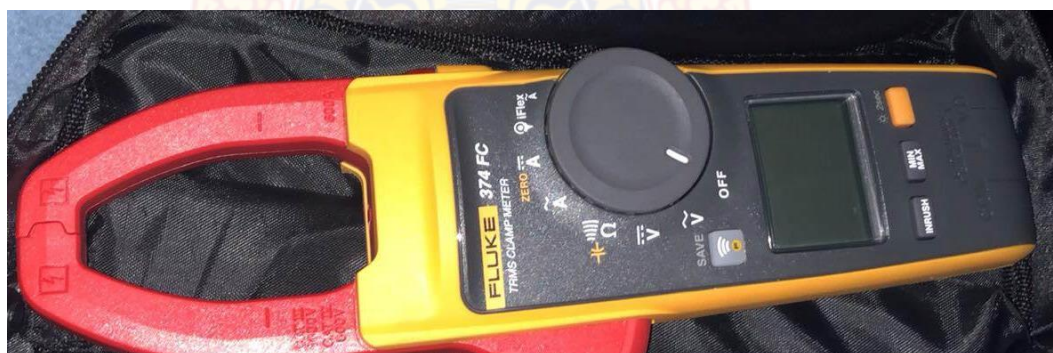
ภาพที่ 3.9 เครื่องมือวัดค่าพลังงานไฟฟ้า
