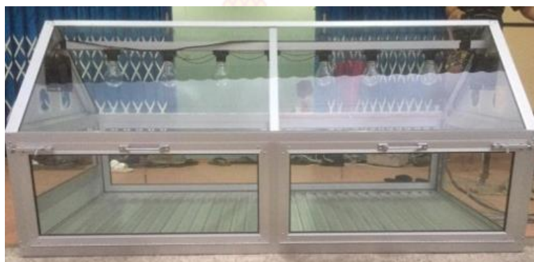
ภาพที่ 4.7 โครงสร้างตู้อบแห้งพลังงานแสงอาทิตย์ (Vac)
