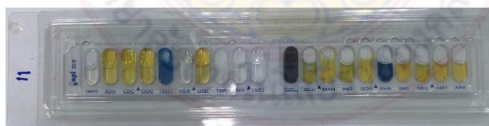
ภาพที่ 7 แสดงการหยดเชื้อลงบนชุดทดสอบ Analytical Profile Index (API®20 E)
