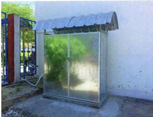
รูปที่ 3.11 ออกแบบและสร้างหลังคากันฝนของเครื่องเติมลมยางอัตโนมัติ
