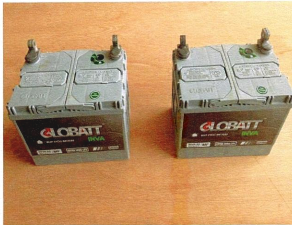
รูปที่ 3.5 ชุดแบตเตอรี่แห้งขนาด 60 แอมแปร์-ชั่วโมง จำนวน 2 ลูก
