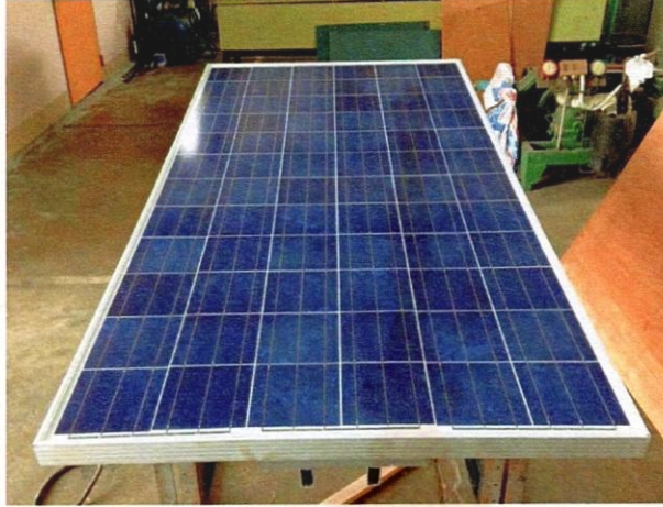
รูปที่ 3.3 ชุดแผงโซลาร์เซลล์ขนาด 280 วัตต์
