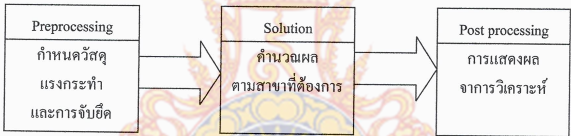
รูปที่ 2.6 ขั้นตอนการคำนวณของระเบียบวิธีไฟไนต์เอลิเมนต์
