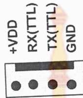
รูปที่ 2.11 แสดง Connector สำหรับอ่านค่า Key Code แบบ ASCII CODE [6]
