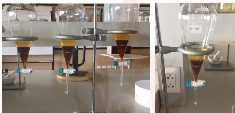
ภาพที่ 3.3 การแยกชั้นของไบโอดีเซลและกลีเซอรอล
