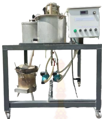
ภาพที่ 3.4 ระบบผลิตไบโอดีเซลจากน้ำมันกรดไขมันอิสระต่ำโดยใช้ความร้อนจากเตาชีวมวล
