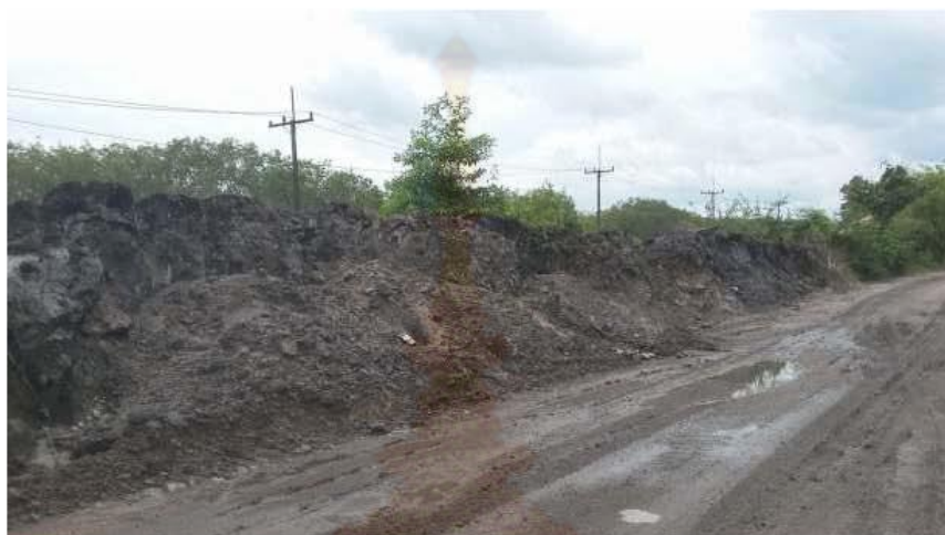
ภาพที่ 2 กองฝุ่นหินเหลือทิ้งในบริเวณโรงงานผลิตแอสฟัลต์คอนกรีต
