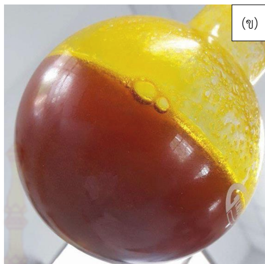
รูปที่ 4-9 น้ำมันปาล์มดิบที่กวนผสมกับกรดฟอสฟอริกร้อยละ 5 ที่อุณหภูมิ 50 องศาเซลเซียส (ก) และ 80 องศาเซลเซียส (ข) เป็นเวลา 30 นาที
