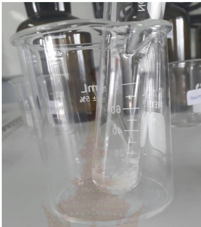
รูปที่ 4-2 ลักษณะของซีเถ้าสีขาวที่ได้จากการเผาน้ำมันตัวอย่างเพื่อวิเคราะห์ปริมาณฟอสฟอรัส
