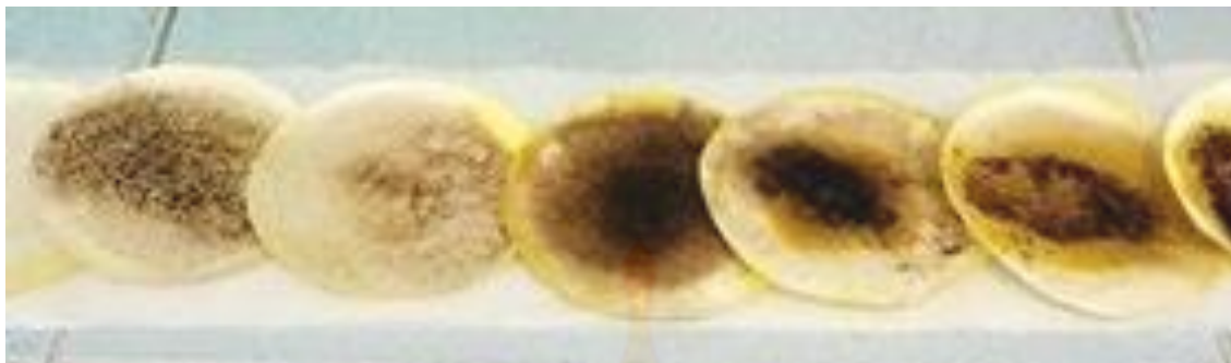
รูปที่ 4-5 ยางเหนียวที่กรองได้จากน้ำมันหลังผ่านการกำจัดยางเหนียวด้วยน้ำร้อนร้อยละ 0.0, 1.0, 2.0, 3.0, 4.0, และ 5.0 โดยน้ำหนัก ที่อุณหภูมิ 50 องศาเซลเซียส เป็นระยะเวลา 30 นาที
