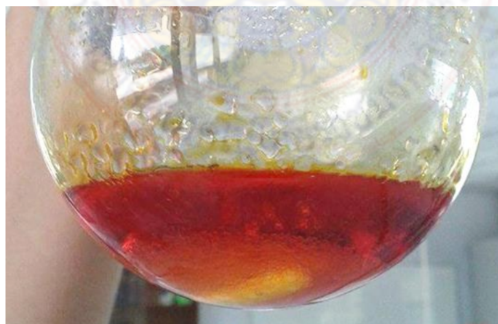
รูปที่ 4-4 ลักษณะการเกิดยางเหนียวในตัวอย่างน้ำมันหลังที่กวนผสมด้วยน้ำร้อนร้อยละ 5.0 โดยน้ำหนัก ที่อุณหภูมิ 50 องศาเซลเซียส เป็นระยะเวลา 30 นาที
