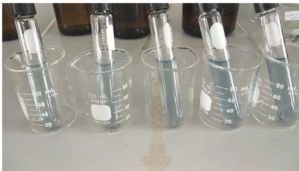
รูปที่ 4-3 ลักษณะของสารละลายที่นำไปวัดค่าดูดกลืนแสงที่ความยาวคลื่น 720 นาโนเมตร เพื่อวิเคราะห์ปริมาณฟอสฟอรัส
