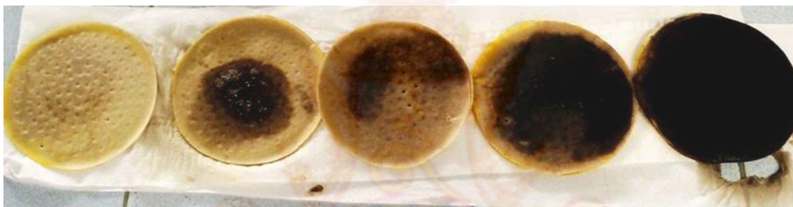
รูปที่ 4-10 ลักษณะของยางเหนียวที่กรองแยกได้จากการกำจัดด้วยฟอสฟอริกร้อยละ 5 ที่อุณหภูมิ 50, 60, 80, 100, และ 120 องศาเซลเซียส ตามลำดับ
