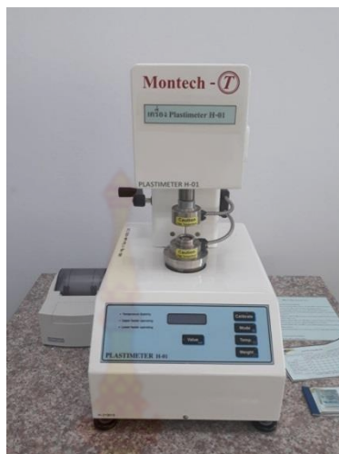
ภาพที่ 2.9 เครื่องทดสอบดัชนีความอ่อนตัว
