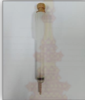
ภาพที่ 2.3 ขั้ว Ag/AgCl saturated เป็น reference electrode
