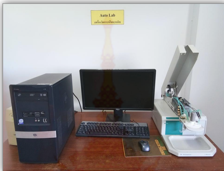
ภาพที่ 2.1 เครื่อง VA 797 CompuTrace Analyzer connected to a Metrohm.VA 797 multimode electrode
