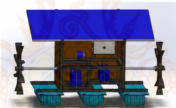
ภาพ2เครื่องเติมอากาศที่ผิวน้ำสำหรับการเลี้ยงปลาในกระชังด้วยพลังงานแสงอาทิตย์ที่ออกแบบขึ้น
