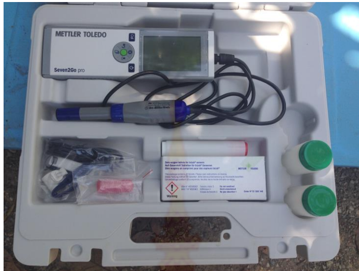
ภาพที่ 3.18 อุปกรณ์วัดค่าปริมาณออกซิเจนที่ละลายในน้ำ (Dissolve Oxygen : DO)
