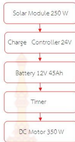
ภาพ 3 บล็อกไดอะแกรมการทำงานของเครื่องเติมอากาศที่ผิวน้ำ
