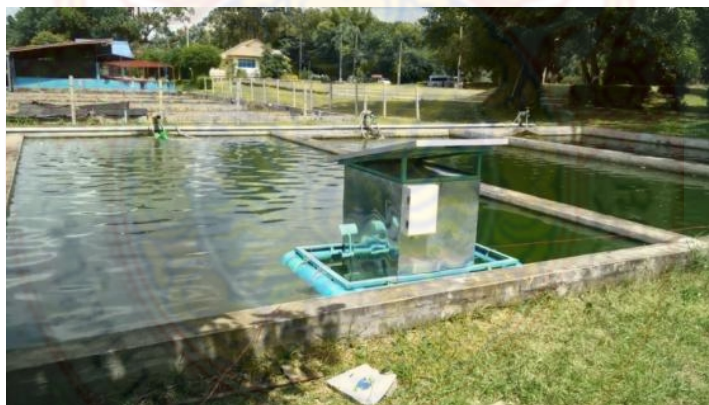
ภาพที่ 2.18 ทดสอบประสิทธิภาพของเครื่องเติมอากาศในน้ำ
