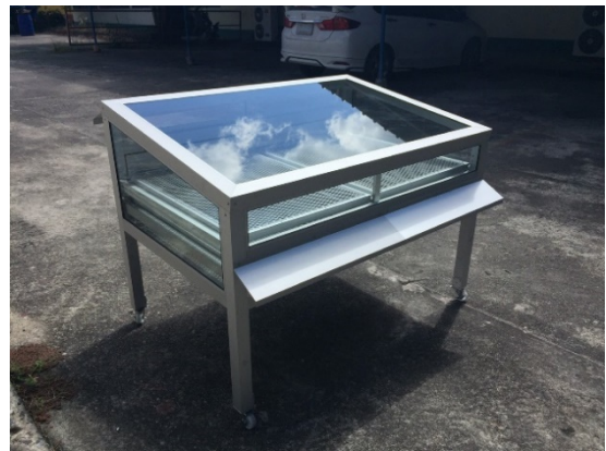
ภาพที่ 3.2 โครงเครื่องอบแห้งพลังงานแสงอาทิตย์สำหรับการแปรรูปเมล็ดโกโก้
