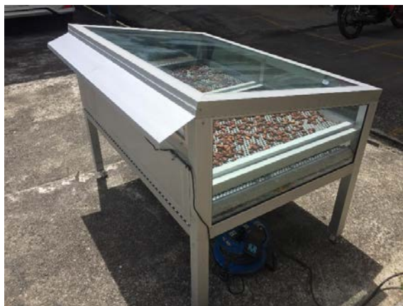
ภาพที่ 4.4 ทดลองวัดค่าอุณหภูมิภายในและภายนอกตู้อบ
