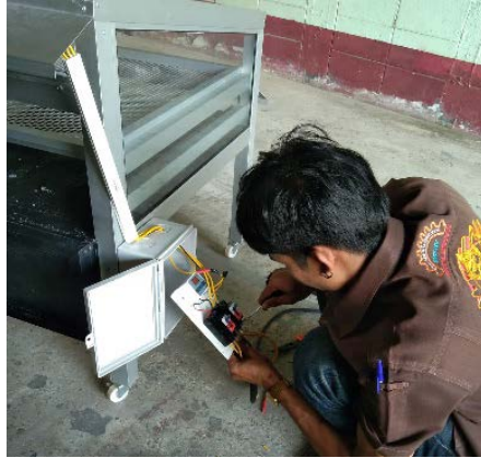
ภาพที่ 3.7 การติดตั้งกล่องไฟฟ้าและวงจรไฟฟ้าในตัวเครื่อง
